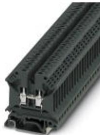
Borne de paso, tensión nominal: 800 V, corriente nominal: 32 A, tipo de conexión: Conexión por tornillo, número de conexiones: 2, sección: 0,5 mm<sup>2</sup> - 6 mm<sup>2</sup>, AWG: 20 - 10, anchura: 6,2 mm, color: gris oscuro, clase de montaje: NS 35/7,5, NS 35/15, NS 32
