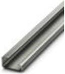
Carril simétrico sin perforar, Perfil G, anchura: 32 mm, altura: 15 mm, según EN 60715, material: Acero, galvanizado, pasivado de capa gruesa, longitud: 2000 mm, color: plateado
