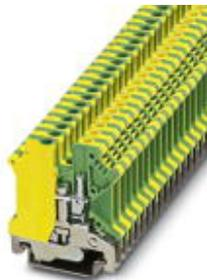
Borne de tierra, tipo de conexión: Conexión por tornillo, número de conexiones: 2, sección: 0,5 mm<sup>2</sup> - 6 mm<sup>2</sup>, AWG: 20 - 10, anchura: 6,2 mm, color: amarillo-verde, clase de montaje: NS 35/7,5, NS 35/15, NS 32
